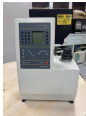
図 2 接触型スキャナー Procera Scanner Mod 50 (Nobel Biocare)
